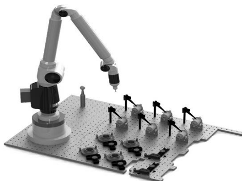
Рисунок 2 – Координатно-вимірювальна машина, побудована на основі маніпуляторів типу «рука»
