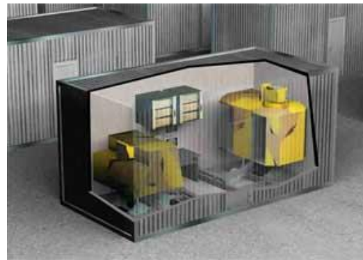
Рисунок 6 – Мобильный тренажер (ХКБМ) выполненный в 20 футовом контейнере.
