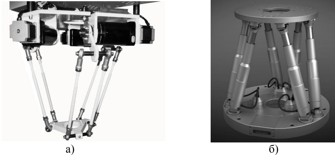
Рисунок 3 – Маніпулятори для координатно-вимірювальних машин, побудовані на основі механізмів з паралельною структурою: а) трипод; б) гексапод.
